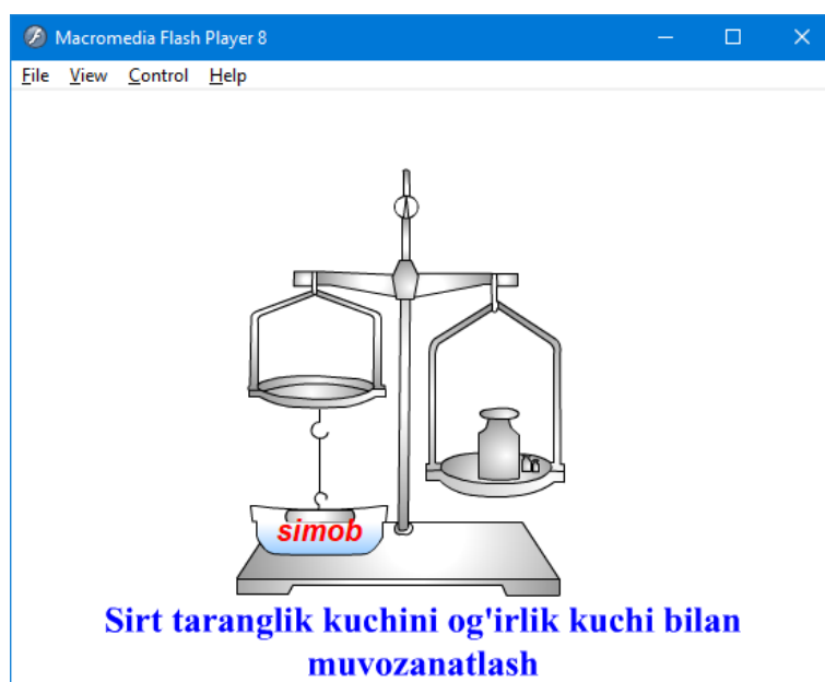
1-rasm. Sirt taranglik kuchini og'irlik kuchi bilan muvozanatini simobda multimedia asosida o'rgatish jarayonini tasviri.
