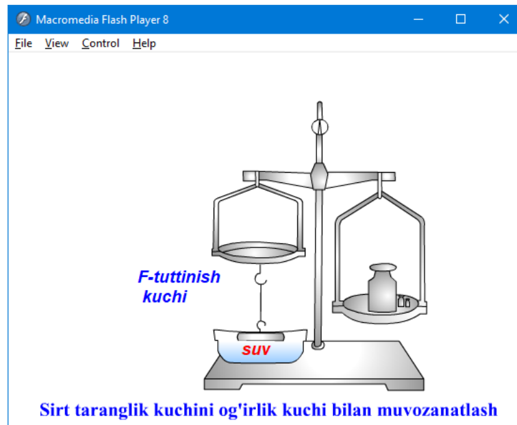
2-rasm. Sirt taranglik kuchini og'irlik kuchi bilan muvozanati suvda multimedia asosida o'rgatish jarayonini tasviri.
