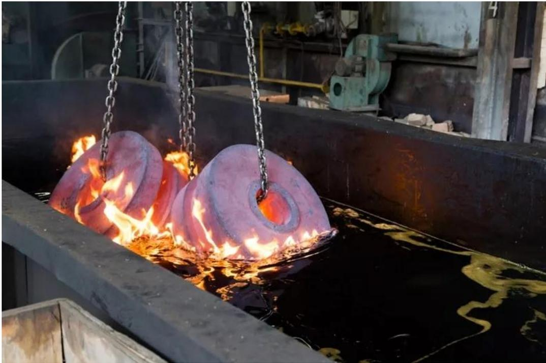
*Рис.1. Охлаждения стальных материалов с маслом.*
