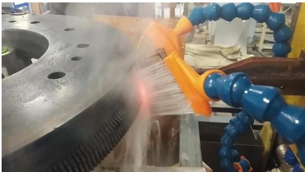
*Рис.3. Охлаждения стальных материалов с водами.*
