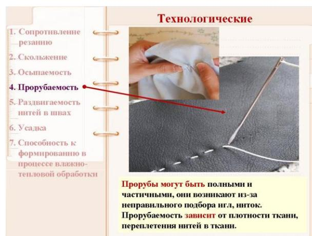
**Явная прорубаемость** образуется тогда, когда игла, проходящая сквозь толщу материала, не раздвигает нити полотна, а разрывает петлю. Результатом такой прорубаемости становится постепенное распускание петель и появление «стрелок» в местах проколов.[2]
