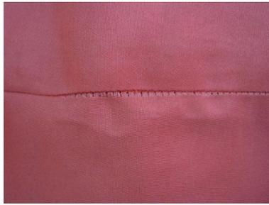
Для испытания прорубаемости ткани пробу 100×200 мм складывают пополам и прокладывают четыре параллельные строчки частотой 7 стежков в см без швейных ниток. Иглы подбирают в соответствии с видом ткани.
