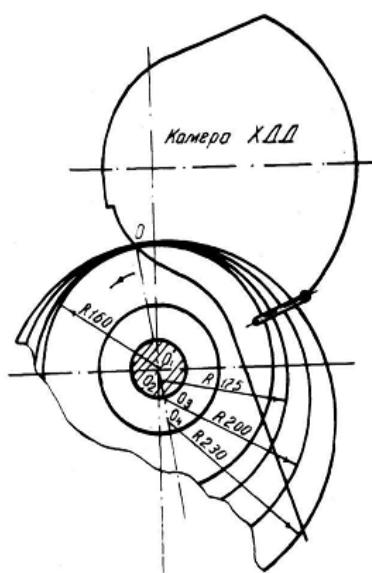
**1.5. Rasm XDD jini ishchi kamerasi bilan xar hil diametrli arrali slindrning joylashish sxemasi.**
