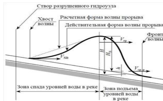
Рис 1. Схематический продольный разрез волны прорыва
