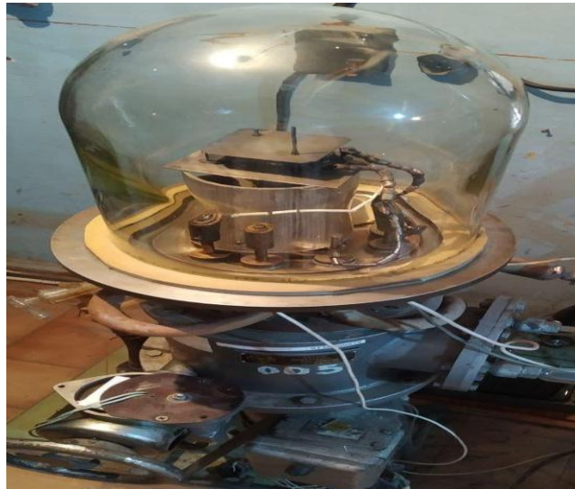
Рисунок 1. Установка вакуумного устройства для получения тонкослойных гетероструктур.
